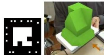
Fig. 17. Marcador R.A y Visualización de un objeto 3D en R.A. con marcador. Fuente: Lopera, 2010.
