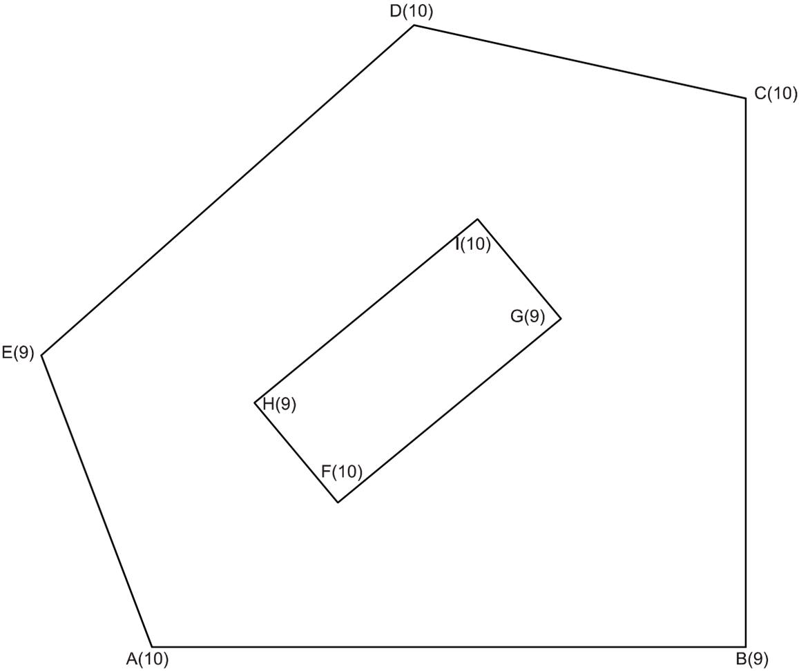
Resolver la cubierta cuya planta se representa a escala 1/100, sabiendo que la pendiente de los faldones es uniforme y 2/3, que existen medianeras donde no se puede verter agua y la totalidad de los alerós son horizontales y tienen la misma cota.
