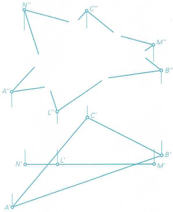
Hallar las proyecciones del segmento común a las "chapas"  $ABC$  y  $LMN$ . Completar la proyección vertical dibujando partes visibles y ocultas.
