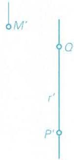
(\* Los puntos  $P'-P''$  y  $Q'-Q''$  pertenecen a la recta  $r'-r''$ . Determinar la proyección horizontal de la recta  $\alpha$  que corta a  $r$  y contiene al punto  $M'-M''$ .
