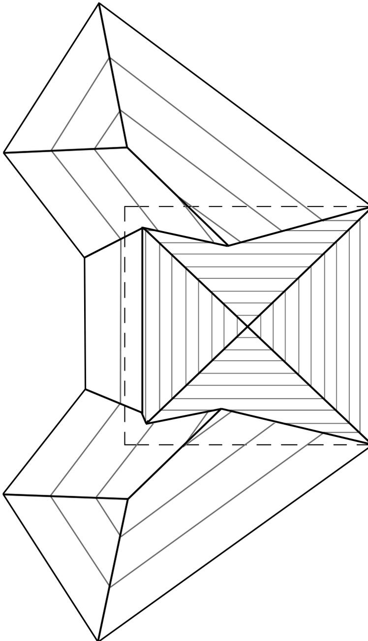
la planta de este edificio presenta puntos de cota de distinto nivel de sus aleros. La parte rallada representa una medianera, la pendiente de los aleros exteriores es de 45° y la pendiente de los del patio interior es de 71%
