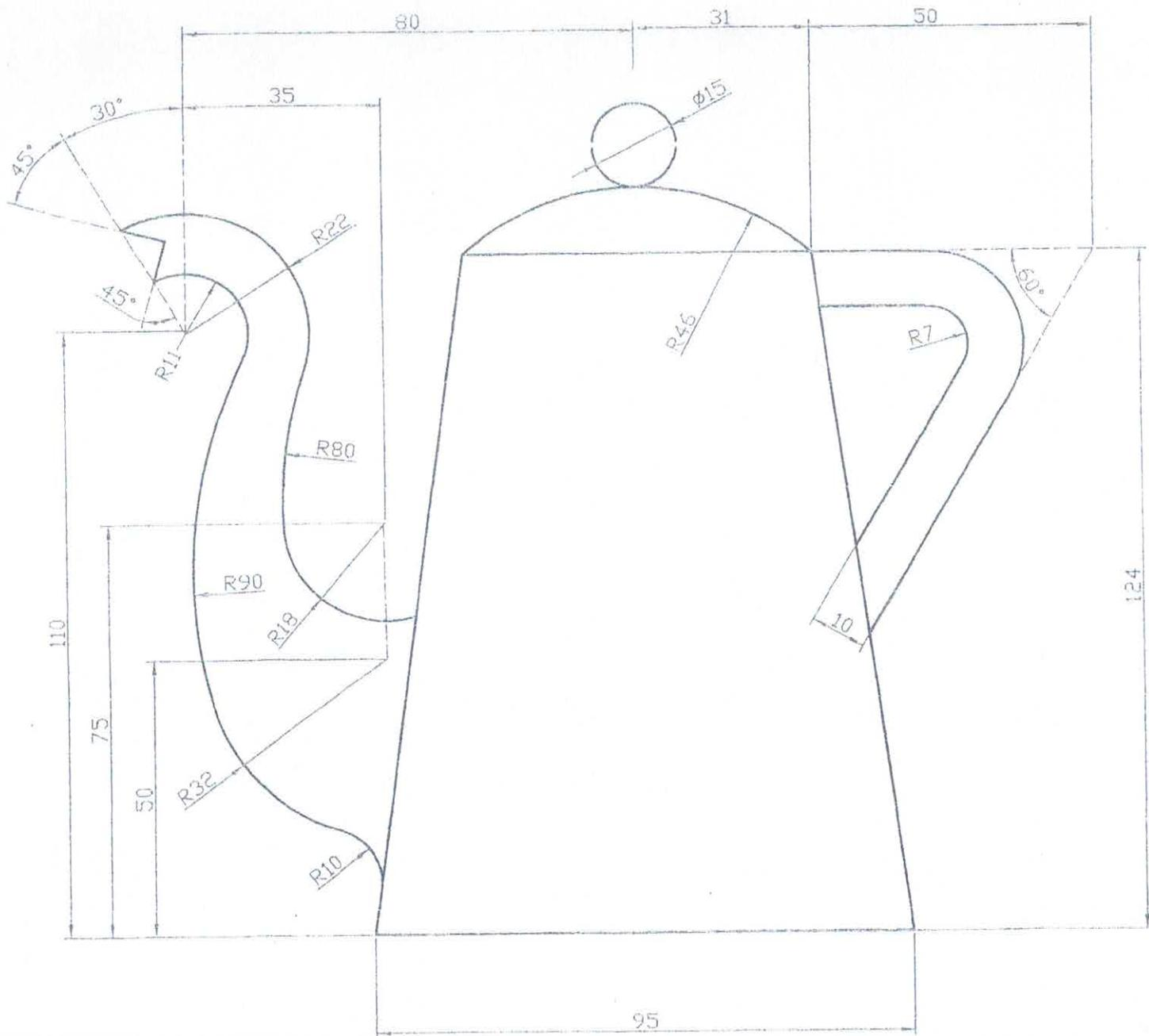
Dada el perfil croquizado (Figura 41) y sitúa en él la recta tangente  $t$  con la condición angular que se expresa. Determina con precisión los centros y los puntos de tangencia de las circunferencias.
